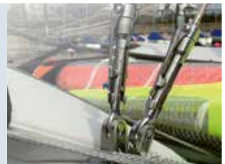
Endstücke zum Aufpressen für Wantenspanner QRT Endstück zum Aufpressen mit Blockierschraube für QRT Wantenspanner von Blue Wave.
