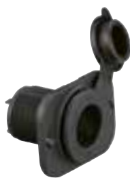
Einbausteckdose für Zigarettenanzünder Aus Nylon. Masse: 60 x 42 mm, Ausschnitt Ø 29 mm
