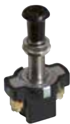
Schubschalter aus Messing, 2-polig, (On/Off) Max. 10 A, Schaft 8 mm, für Wand max. 15 mm
