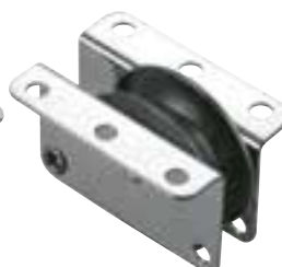
Einfacher Einbaublock Für gerade Fläche Rolle Ø 40 mm aus Nylatron
