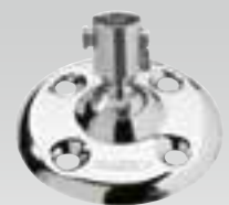
Kugelgelenk auf Platte Aus rostfreiem Stahl Befestigung mit 4 Schrauben von Ø 5 mm. Achse: Ø 4.8 mm Ø 55 mm, Höhe: 32 mm
