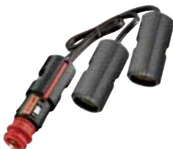
Adapter mit Universalstecker und zwei Steckdosen Ø 21 mm mit 25 cm Kabel. 10 A Sicherung.
