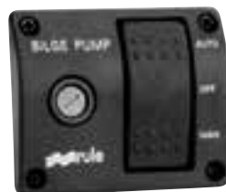
Automatischer Schalter 3 Positionen: Automatic, Manual und Off. Mit Kontrolllampe und Sicherung. Automatische Rückstellung von Manual auf Off. Masse: 75 x 61 mm
